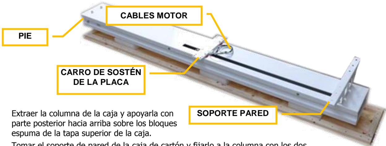
Extraer la columna de la caja y apoyarla con parte posterior hacia arriba sobre los bloques espuma de la tapa superior de la caja.
