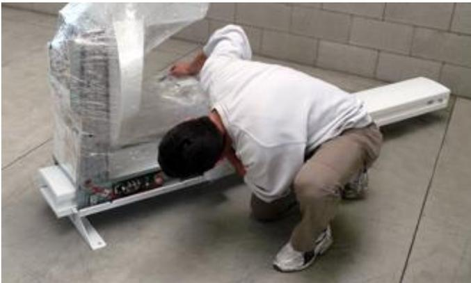
Aflojar los pernos de seguridad, sin quitarlos, para separar la placa de sujeción del carro de la columna y dar cabida a los espaciadores que serán montados después.
